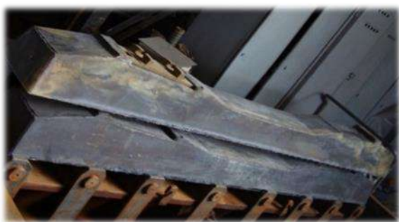
Рисунок 1.8 – Пластиковая шпала, армированная полым металлическим вкладышем [23]
