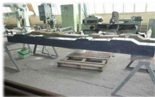
Рисунок 1.9 – АПАТЭК, Мостовой брус из композитных материалов [29]
