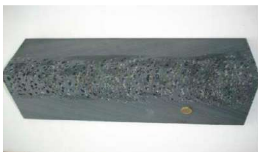
Рисунок 1.12 – Германия, МРВ композиционная шпала, Смешанные пластиковые отходы и изношенные стекловолокна, вспомогательные компоненты [34]
