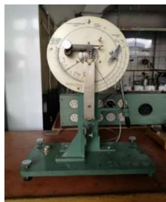
Рисунок 2.9 – Схема (а) и прибор «Динстат» (б) для определения удельной ударной вязкости материала
