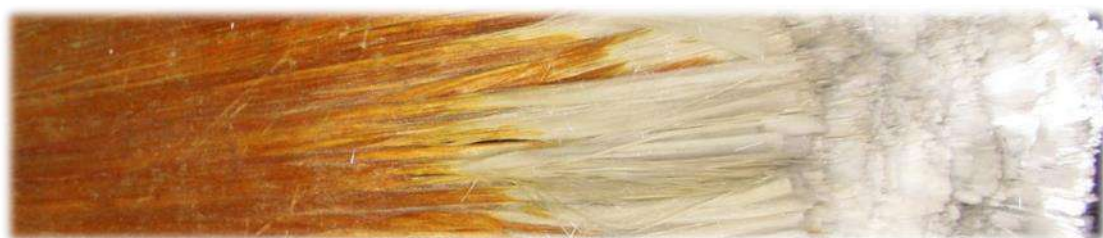
Рисунок 1.15 – Sekisui FFU; Япония; полиуретановая пена и стекловолокно [52]
